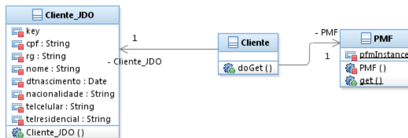
Figura 14. Diagrama de classe da aplicação Java
